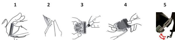
**Justering av klipplängden med hjälp av de tillhörande kammarna.**
